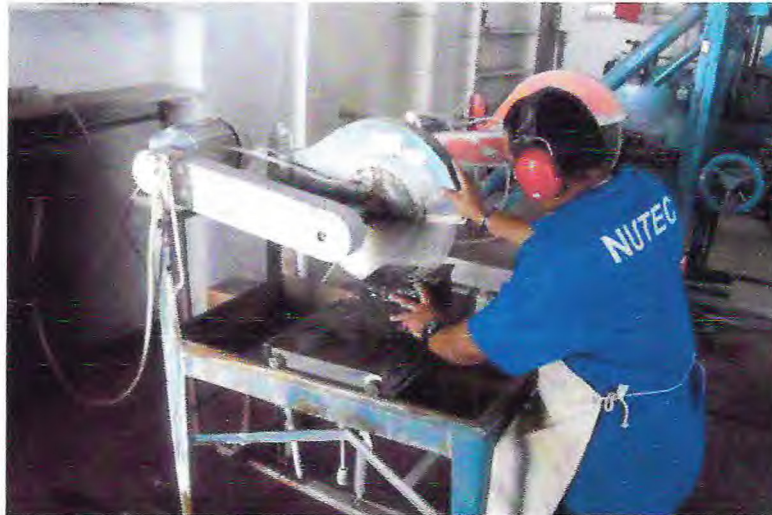
Figura 11 - Operação de corte de amostras em lamina diamantada realizadas no NUTEC. Técnico operando a máquina de corte (Fonte: Autores).
