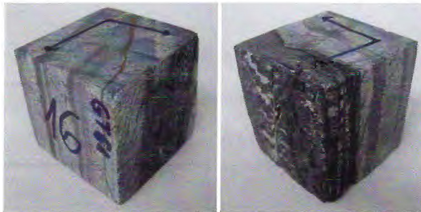
Figura 44 - Amostra GT 61. a) cubo 16; b) cubo 17. O corpo 16 apresenta bandas mais espessa de sílica cristalizada que o corpo 17. (Fonte: Autores)
