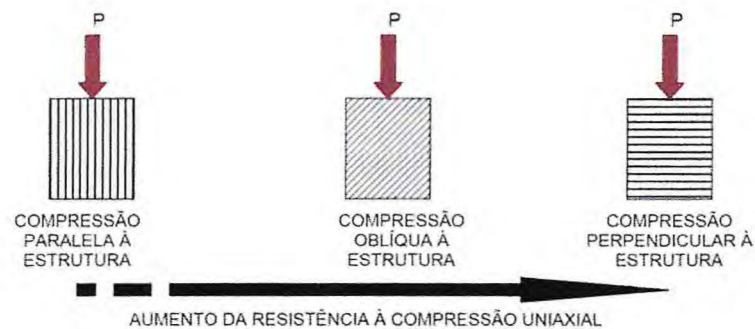
Figura 45 - Esquema ilustrando a influência de uma estrutura planar na maior ou menor resistência à compressão uniaxial de uma rocha. P = compressão. (IAMAGUTI, 2001).
