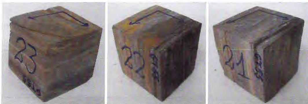
Figura 48 - Amostra GT 55. Aumento da resistência nos corpos da esquerda para a direita. a) cubo 23 (R=19,2); b) cubo 22 (R=67,1); c) cubo 21 (R=116,3). (Fonte: Autores)
