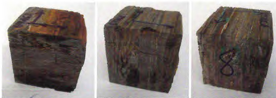
Figura 49 - Amostra GT 16A. Aumento da resistência nos corpos da esquerda para a direita. a) cubo 6 ( R=8,8 ); b) cubo 7 ( R=12,3 ); c) cubo 8 ( R=48,8 ). (Fonte: Autores)
