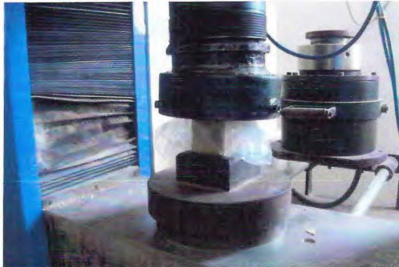
Figura 13 - Realização do ensaio de compressão uniaxial realizada na Máquina Universal de Ensaio, no laboratório do NUTEC (Fonte: Autores).
