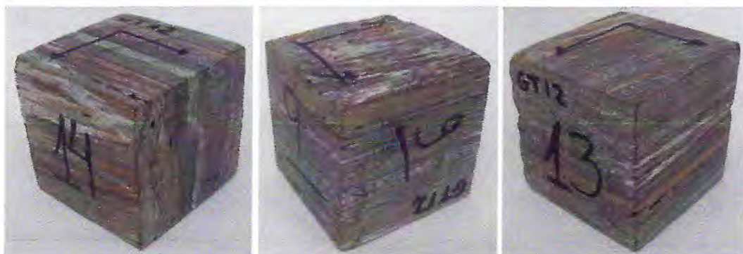
Figura 46 - Amostra GT 12. Aumento da resistência nos corpos da esquerda para a direita. a) cubo 14; b) cubo 9; c) cubo 13. (Fonte: Autores)
