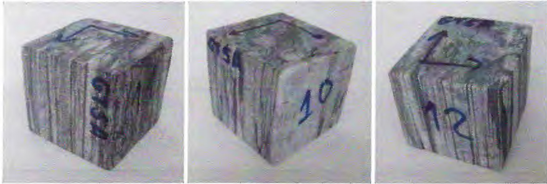
Figura 43 - Amostra GT 5A. Aumento da resistência nos corpos da direita para esquerda. a) cubo 11 ( R=13,6\text{MPa} ); b) cubo 10 ( R=32,3\text{MPa} ) e c) cubo 12 ( R=89,0\text{MPa} ). (Fonte: Autores)
