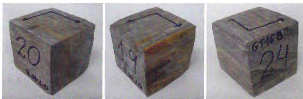
Figura 50 - Amostra GT 16B. Aumento da resistência nos corpos da esquerda para a direita. a) cubo 20 ( R=46,8 ); b) cubo 19 ( R=54,9 ); c) cubo 24 ( R=89,8 ). (Fonte: Autores)
