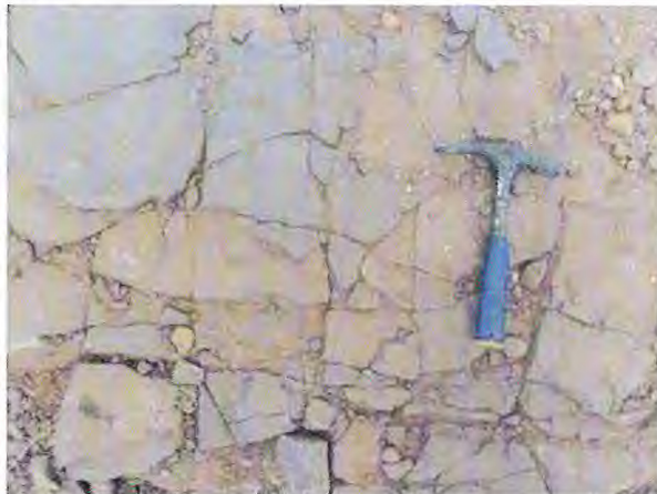
Figura 3.8: Arenito Pacujá com fraturas tendo como direção os pares 350/76 Az; 284/55 Az formando a geometria mais encontrada na região.
