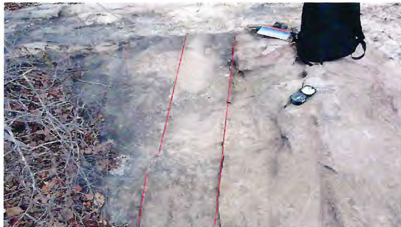
Fig. 5.3: Diáclases paralelas observadas no ponto 12. Atitude: 154°Az/78°. Coordenadas: 0501354 m E / 9416514 m S.
