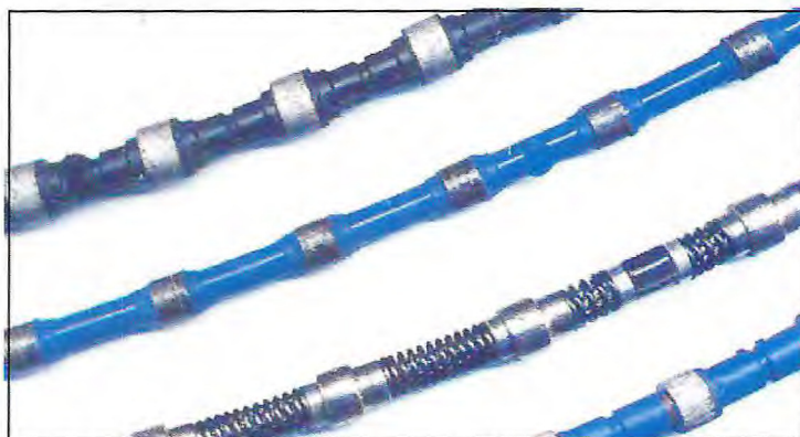
Fig. 6.4: Exemplos de fios diamantados e helicoidais. Extraído de Matta (2003)
