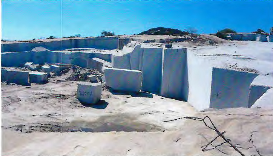
Foto 6.2: Frente de lavra inativa onde não foi usada a técnica de desmonte em bancadas baixas, e foram observadas diáclases subhorizontais geradas por alívio de pressão.
