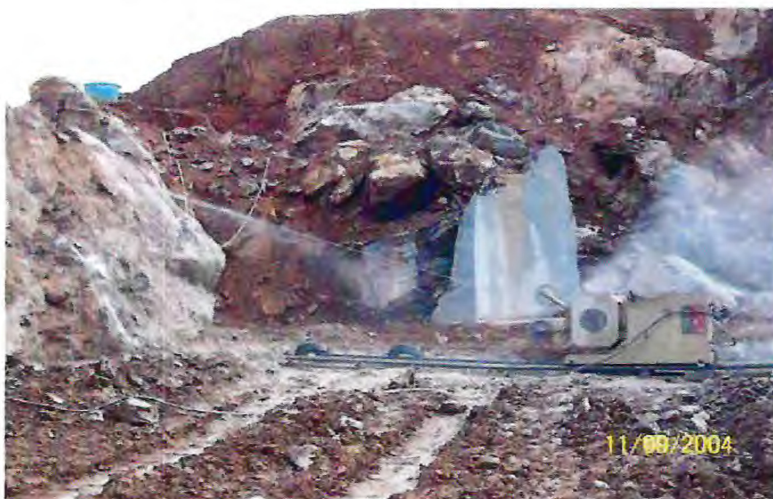
Fig. 6.6: Processo de desmonte de rocha ornamental no sentido vertical usando fio diamantado. Extraído de Almeida (2006)
