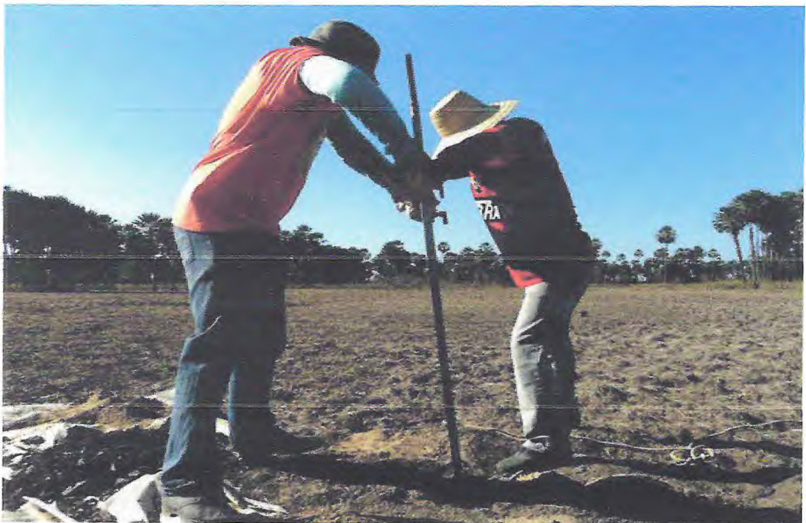
Figura 3: Sondagem a trado manual executada na área de pesquisa
