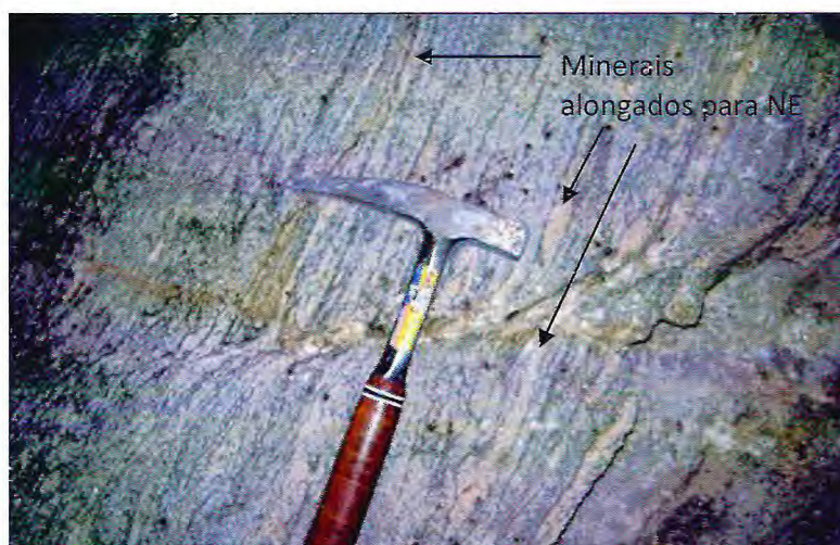
Figura-5.2: Minerais alongados para NE. Estrutura por lineações devido ao alongamento ou estiramento ( L_n ) de minerais, são geradas por processos deformacionais de caráter dúctil. (Afloramento RGM-23 UTM 455932/ 9600403)
