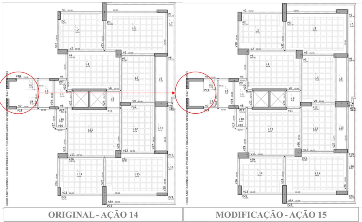
Figura 27 - Segunda alteração nos pilares P10 e P18 (Antigo P12)
