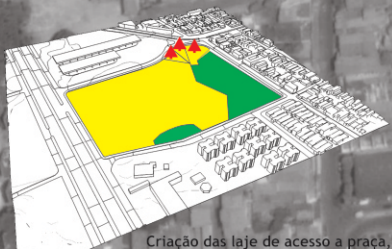
Criação das laje de acesso a praça, cada uma descendo uma cota ate a cota 17.
