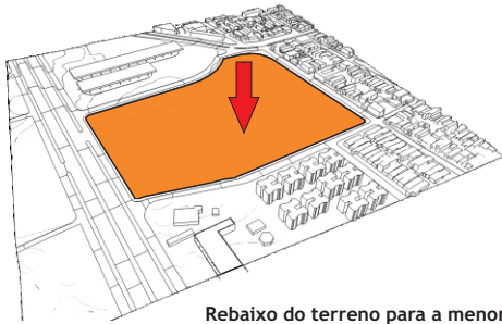
Rebaixo do terreno para a menor cota, a 17.
