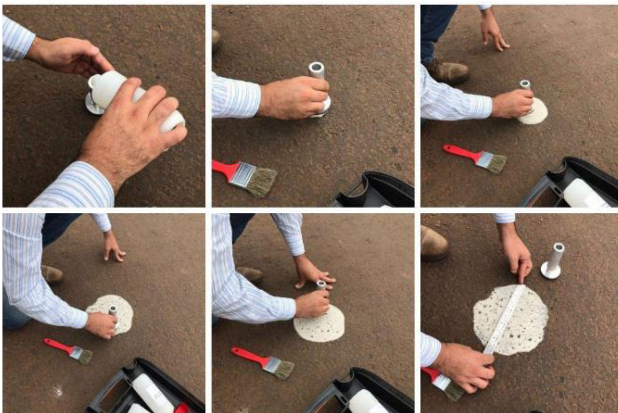
Figura 5 - Ensaio da Mancha de Areia
