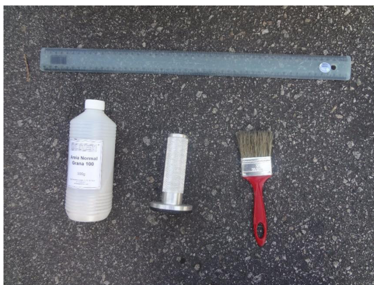
Figura 7 – Areia, soquete, pincel e régua utilizados no ensaio de Mancha de Areia
