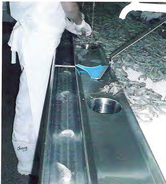
Figura 17 - Mesa para descabeçamento de camarão, semi-automática de dupla canaleta, utilizada na empresa RB Aquicultura Comércio Exportação e Importação Ltda.
