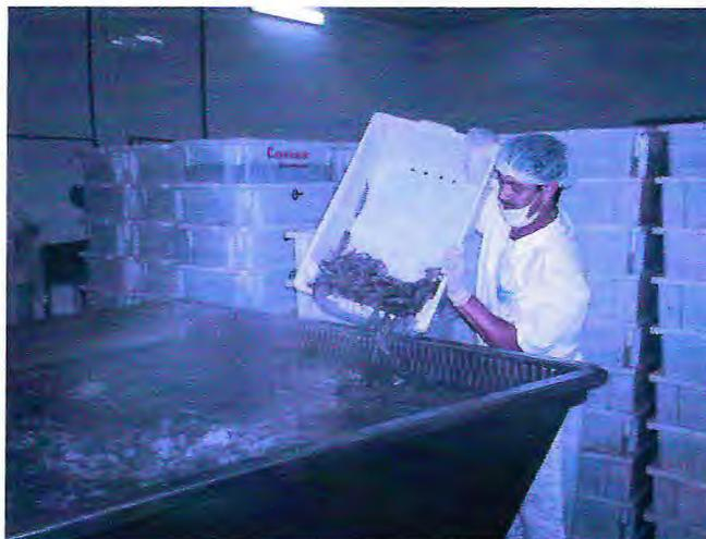
Figura 3 - Tanque separador de gelo na recepção da empresa RB Aquicultura Comércio, Exportação e Importação Ltda.
