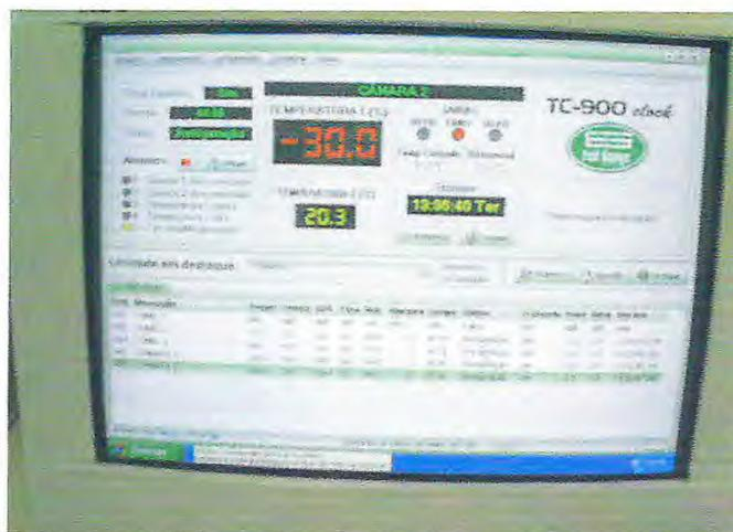
Figura 12 - Controle computadorizado das temperaturas das câmaras frigoríficas na RB Aquicultura Comércio, Exportação e Importação Ltda.
