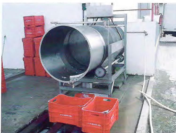
Figura 18 - Lavadora rotativa para peneiramento dos resíduos sólidos na empresa RB Aquicultura Comércio Exportação e Importação Ltda.
