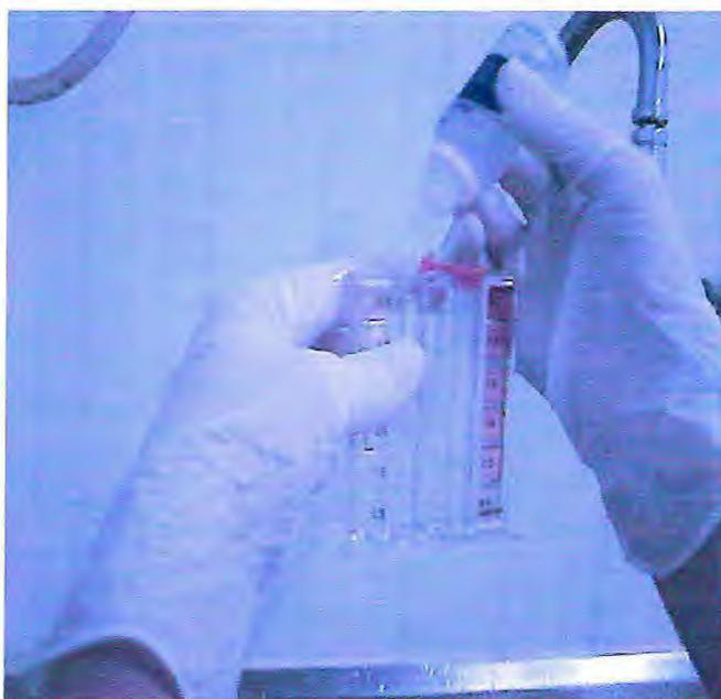
Figura 6 – Kit utilizado para o controle da concentração de cloro na água utilizada no beneficiamento do camarão na empresa RB Aquicultura Comércio, Exportação e Importação Ltda.
