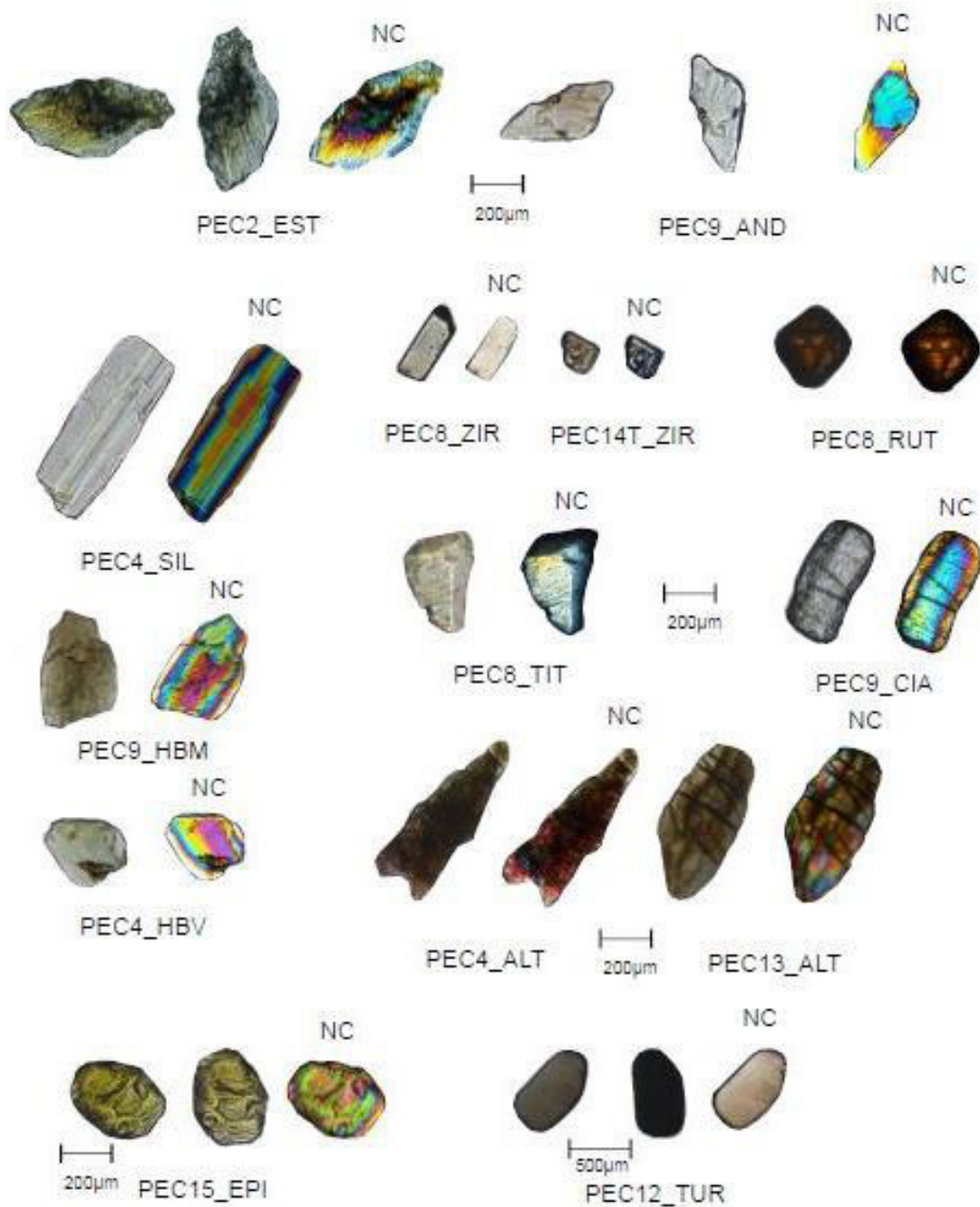
Figura 12. Fotomicrografias dos principais minerais pesados presentes nas amostras identificados com auxílio de microscópio de luz polarizada. À esquerda, com nicóis paralelos e à direita, com nicóis cruzados. Siglas: HBV-Hornblenda Verde; ZOI-Zoisita; TUR-Turmalina; FIB-Fibrolita; EST-Estauroлита; ALT-Alterita; SIL-Silimanita; TIT-Titanita; AND-Andaluzita; ZIR-Zircão; RUT-Rutilo; CIA-Cianita; EPI-Epidoto.
