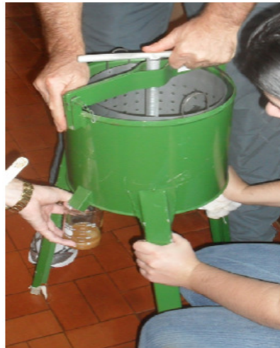
Figura 18 - Mecanismo utilizado para remoção do óleo dos rejeitos de Pescados
