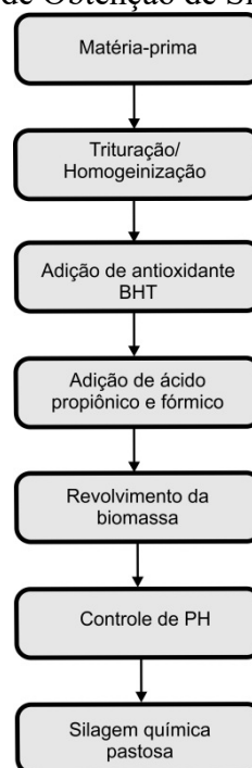
Figura 12 - Fluxograma de Obtenção de Silagem Química de Tilápia
