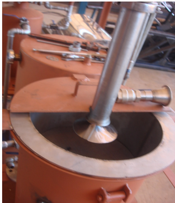
Figura 66 – Sistema de decantação – (a) Distribuidor de líquidos, (b) Acoplamento decantador – Reator
