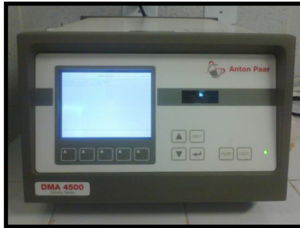
Figura 44 - Densímetro digital marca ANTON PAAR® modelo DMA 4500
