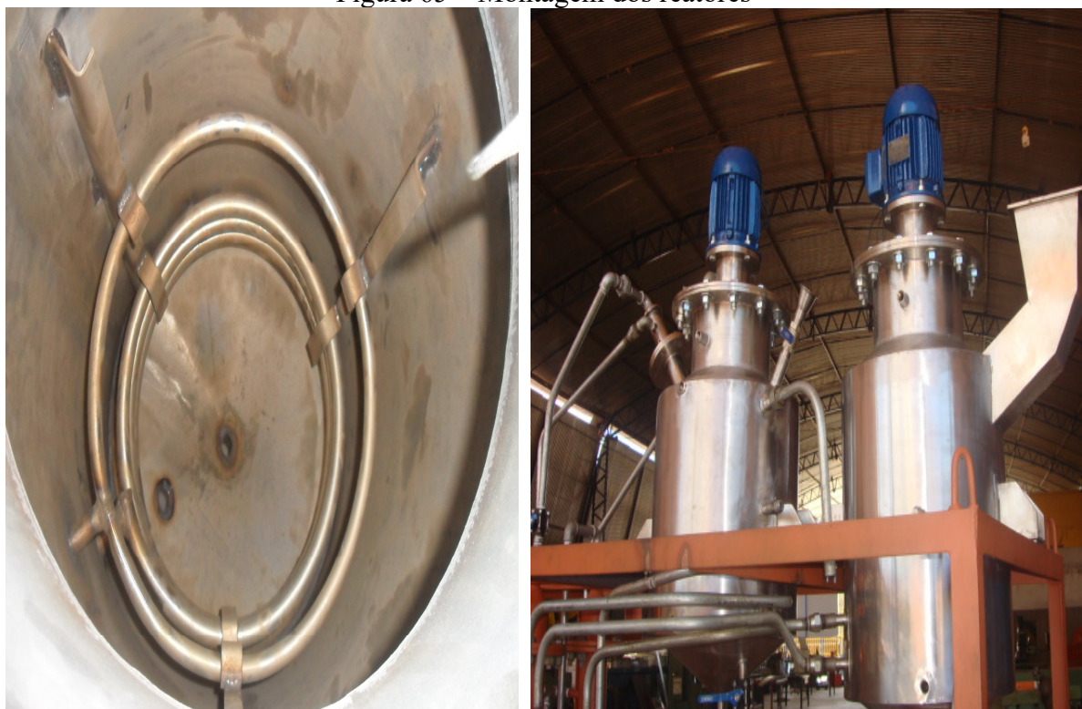
Figura 65 – Montagem dos reatores
