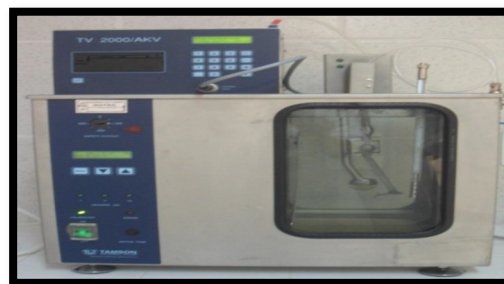
Figura 43 - Aparelhagem utilizada no ensaio de viscosidade: (a) viscosimétrico capilar cannonfenske , (b) Viscosímetro da marca TAMPSON ZOETERMEER- HOLLAND® modelo TV 2000/AKV
