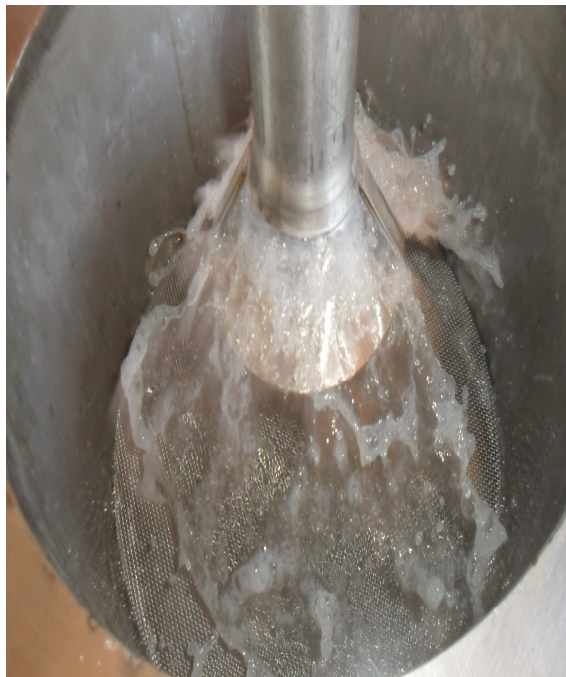
Figura 66 – Sistema de decantação – (a) Distribuidor de líquidos, (b) Acoplamento decantador – Reator
