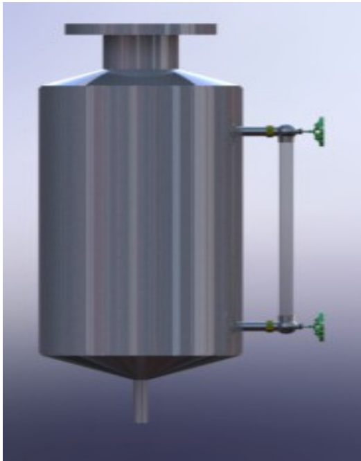
(a) Tanque de coleta de condensados
