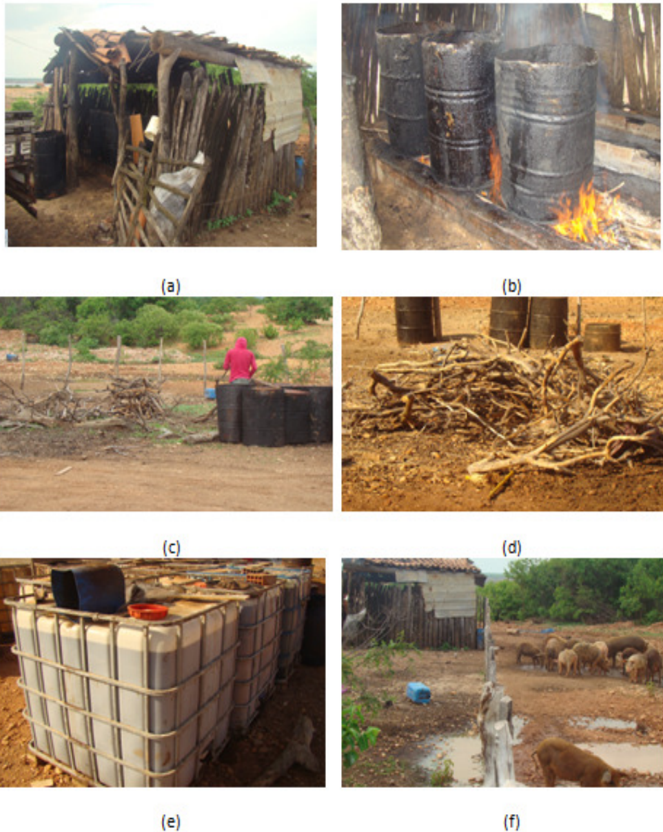
Figura 69 – Metodologia de extração de óleo de vísceras de peixes por membros da cooperativa em Curupati. (a) Casebre, (b) Tanques, (c) e (d) Biomassa utilizada no aquecimento, (e) Tancagem para óleo produzido, (f) Mamíferos presentes na área de produção
