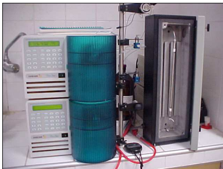
Figura 3.5. Sistema de adsorção em leito fixo com loop de injeção de 20 \mu L.
