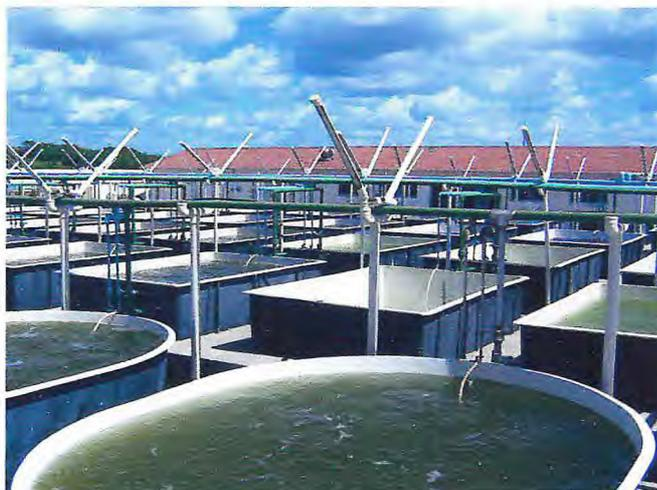
Figura 19. Tanques de 10.000 litros utilizados no cultivo massivo de microalgas no laboratório de pós-larvas da empresa Compescal - Comércio de Pescado Aracatiense Ltda, em Aracati-CE.
