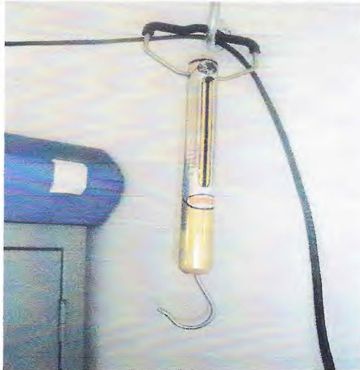
Figura 6. Dinamômetro com capacidade para 10,0 kg
