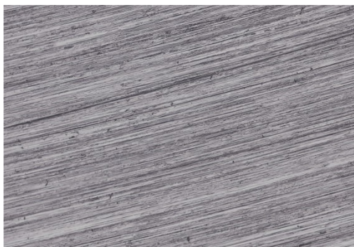
Ensaio de 5 ppm (500 ppm Cl - ) – antes (aumento de 10x)
