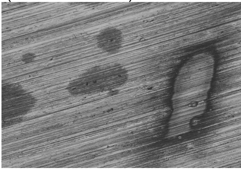
Ensaio de 5 ppm (500 ppm Cl - ) – depois (aumento de 10x)
