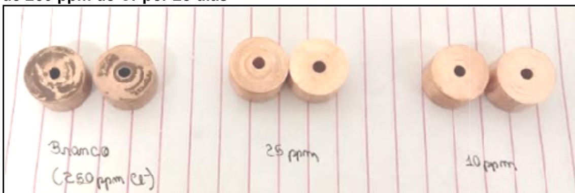
Figura 28 - Registro fotográfico dos corpos de prova após imersão no meio de 250 ppm de Cl^- por 28 dias
