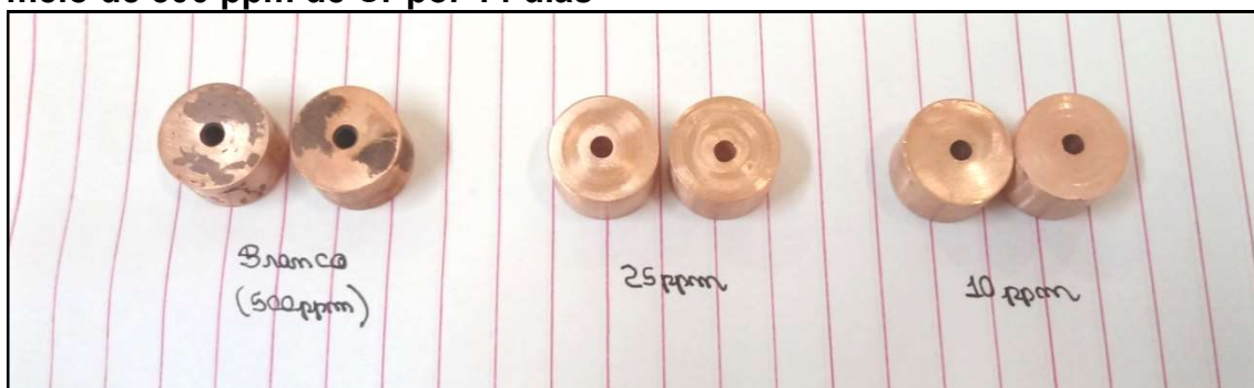
Figura 29 - Registro fotográfico dos corpos de prova após imersão no meio de 500 ppm de Cl - por 14 dias
