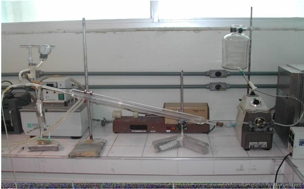
Figura 10: Foto do sistema de perfusão de leito vascular mesentérico.
