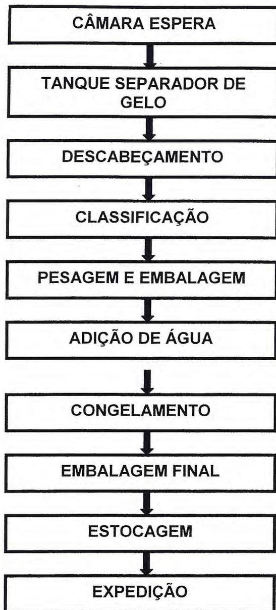
**FIGURA 15** – Fluxograma do processamento do camarão sem cabeça congelado.
