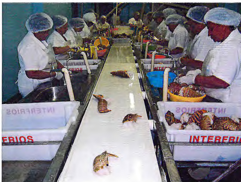
Figura 7 - Operárias posicionadas nas laterais de uma mesa de evisceração para retirada do canal entérico das caudas de lagosta, na Indústria INTERFRIOS – Intercâmbio de Frios S.A., em Fortaleza, Ceará.
