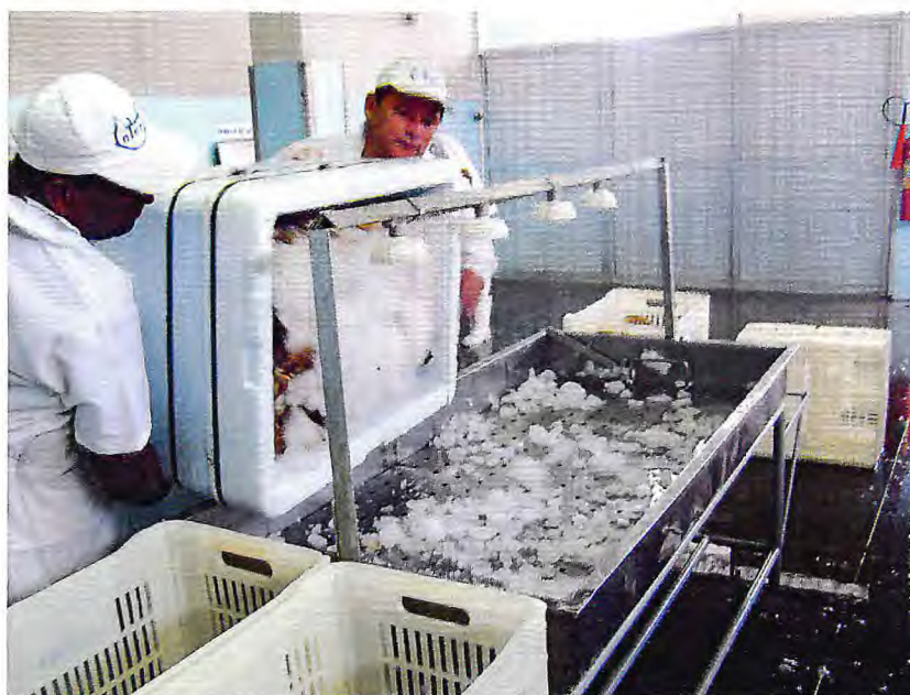
Figura 4 - Mesa de aço inox com chuveiros verticais para a lavagem das Caudas de lagosta na recepção da indústria INTERFRIOS – Intercâmbio de Frios S.A., em Fortaleza, Ceará.
