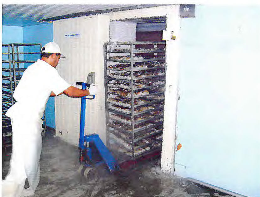
Figura 18 - Caudas de lagosta sendo levadas para o interior do túnel de congelamento na Indústria INTERFRIOS – Intercâmbio de Frios S.A., em Fortaleza, Ceará.
