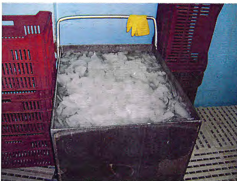
Figura 14 - Tanque de aço inox com solução de tripolifosfato de sódio e gelo na Indústria INTERFRIOS – Intercâmbio de Frios S.A., em Fortaleza, Ceará.
