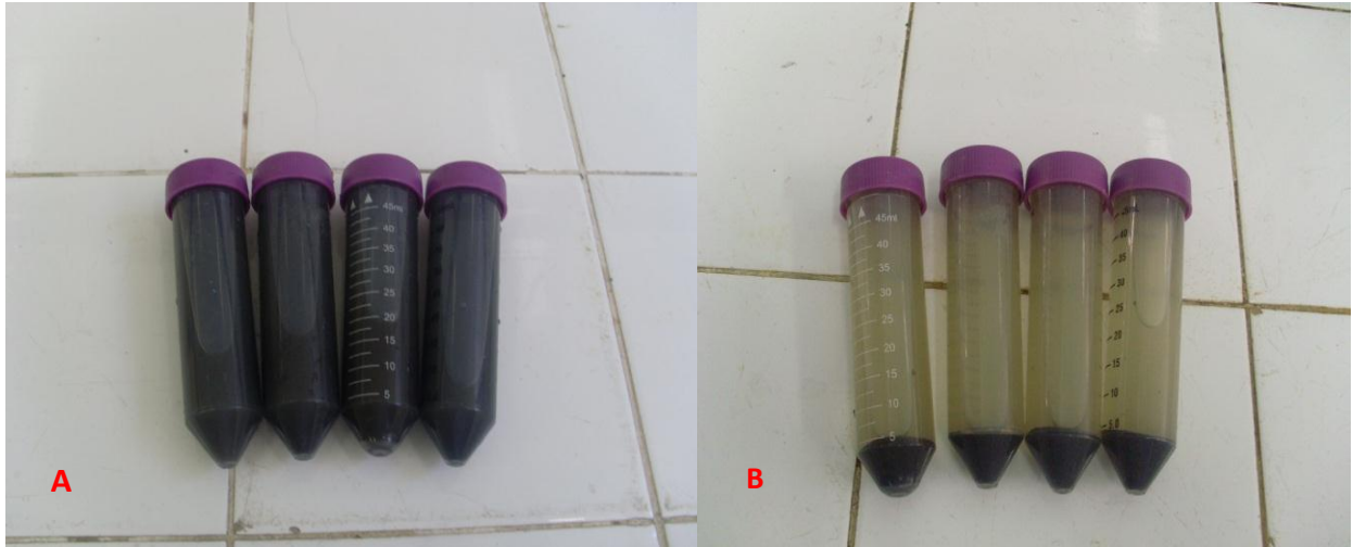
Figura 11 - Amostra para teste de toxicidade. A: Amostra em estado bruto, B: Amostra após passar pelo processo de centrifugação.
