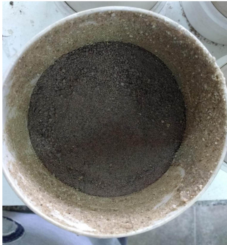
Figura 4: Solo acondicionado na coluna.
