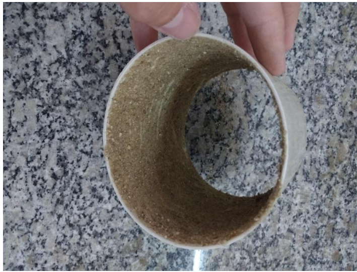
Figura 2. Tubo PVC revestido internamente com areia grossa fixada com cola.
