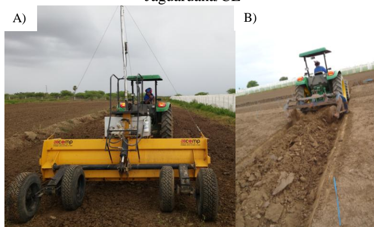
Figura 7 – Preparo da área experimental. A) Plaina Niveladora e B) Taipadeira - BASF, Jaguaruana/CE
