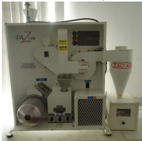
Figura 17 – Provador de arroz - BASF, Limoeiro do Norte/CE
