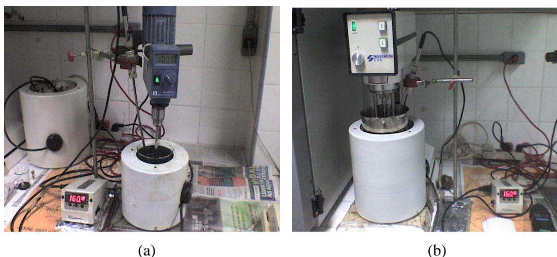
Figura 3.3 – Misturadores: (a) IKA® RW20 e (b) Silverson® L4R utilizados neste estudo
