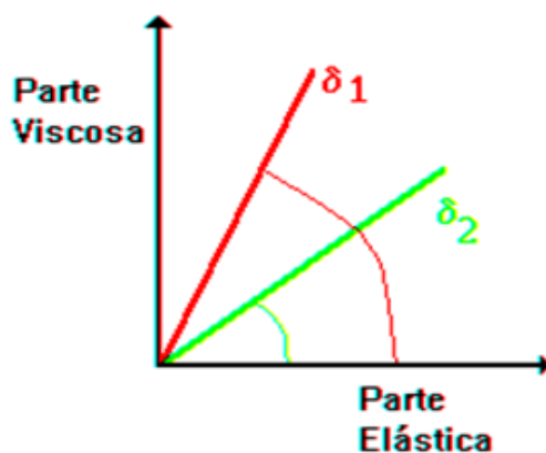
Figura 2.27 – Exemplos de resultados de ângulo de fase para dois tipos de CAP (Bernucci et al. , 2007)
