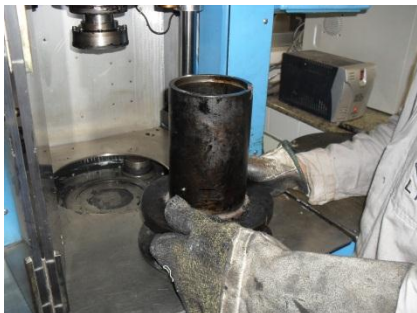
Colocação da mistura no compactador CGS
