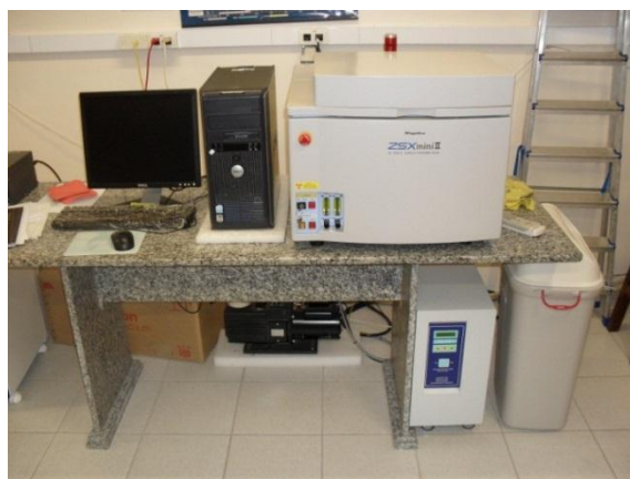
Figura 3.11 – Espectrômetro de fluorescência de Raio-X, do laboratório de Física da UFC, utilizado neste estudo
