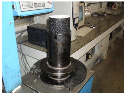
Extração do CP após compactação
