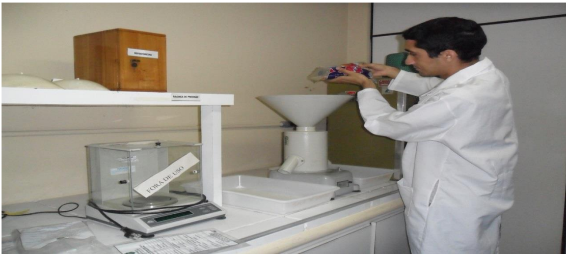
Figura 1- derrame do produto no homogeneizador
