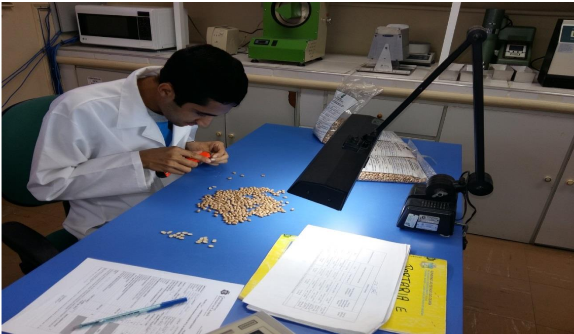
Figura 10- abertura dos grãos para visualização dos defeitos internos
