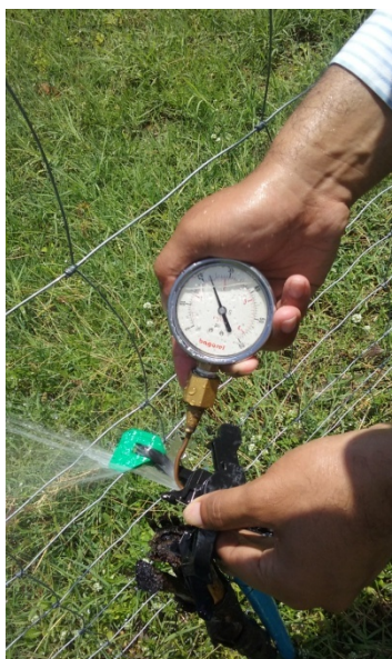
Figura 3- Verificação da pressão de serviço do aspersor com o auxílio do uso do tubo de Pitot acoplado ao manômetro Bourdon, Fortaleza-CE, 2016. Foto: Borges, R. C.
