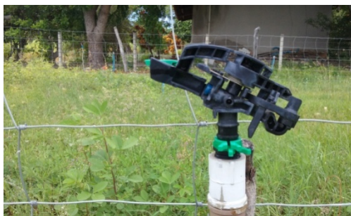
Figura 1 – Aspersor da marca NDJ do modelo 435 ½” M, Fortaleza-CE, 2016. Foto: Borges, R. C.
