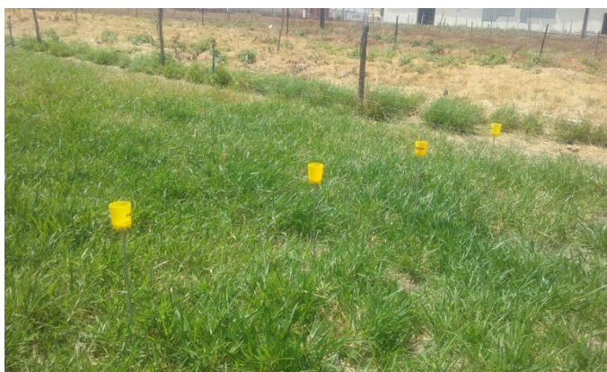
Figura 6 – Disposição dos coletores em campo para determinação da evaporação, Fortaleza-CE, 2016. Foto: Borges, R. C.
