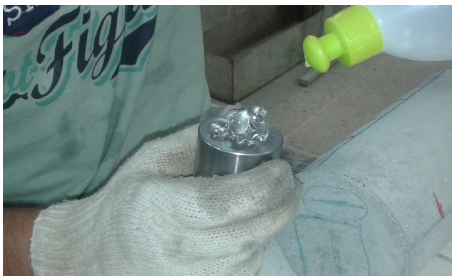
Figura 14 - Aplicação de gel transmissor para possibilitar o perfeito contato entre transdutor e concreto
