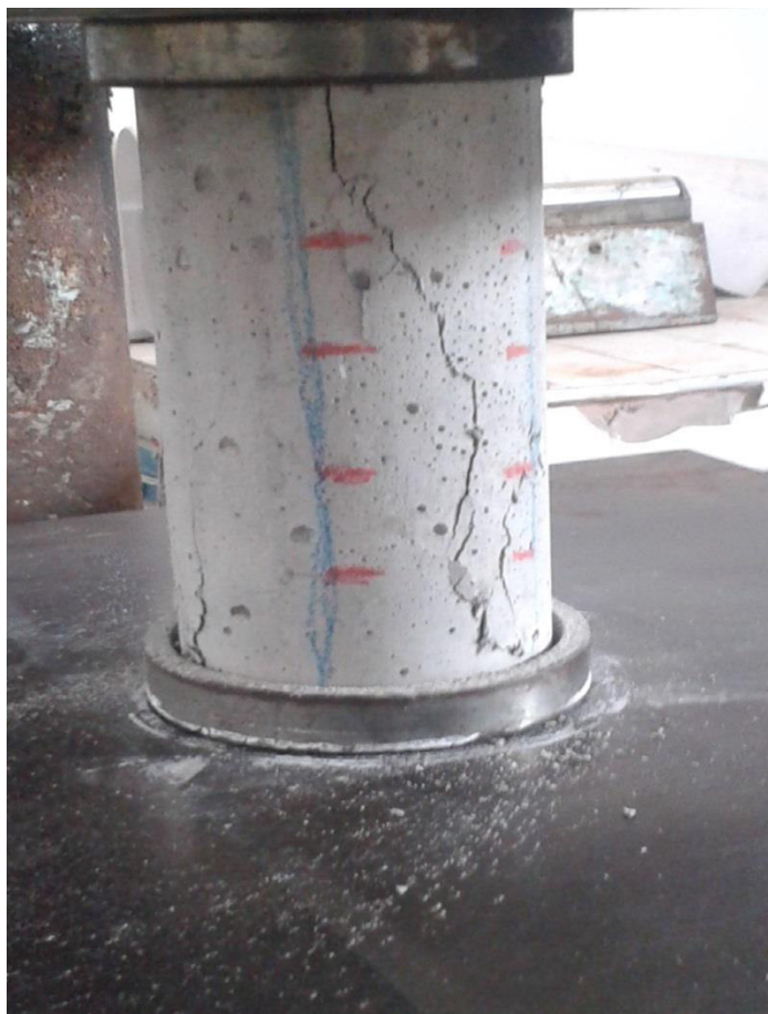
Figura 6 - Momento de Ruptura do Corpo de Prova
