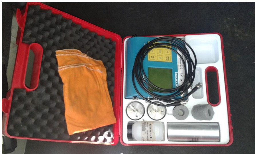
Figura 13 - Instrumento de teste ultrassônico (TICO) e o cilindro de calibração
