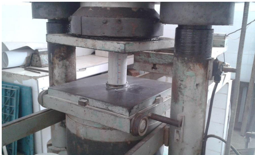
Figura 20 - Prensa hidráulica para ensaio de resistência mecânica a compressão
