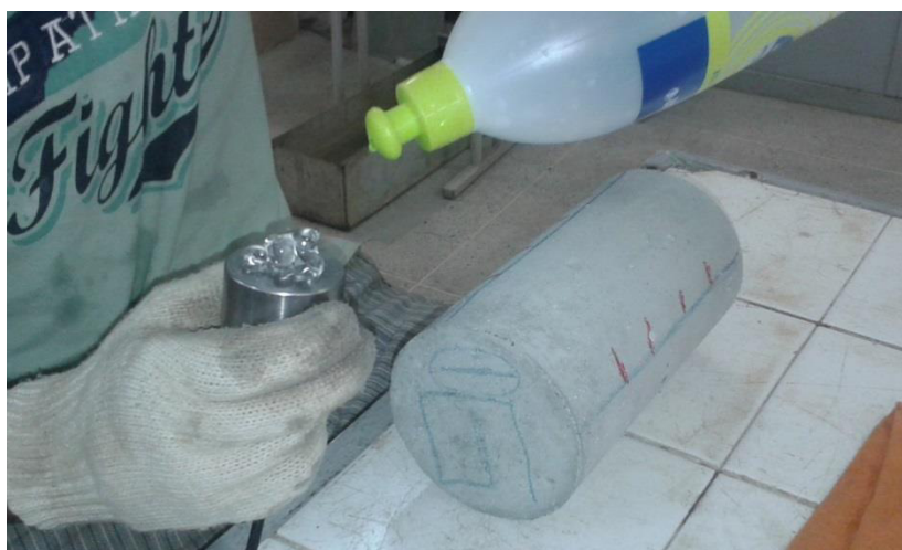
Figura 4 - Aplicação de gel para perfeito contato entre transdutores e concreto
