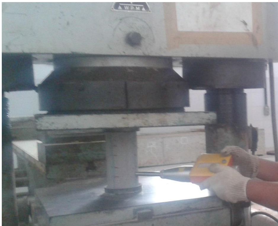
Figura 19 - Realização do ensaio de esclerometria
