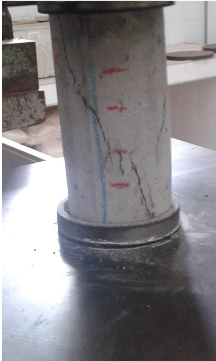
Figura 21 - Momento exato da ruptura do corpo de prova
