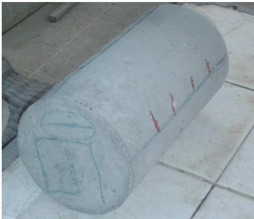
Figura 17 - Demarcação da superfície para realização do ensaio de esclerometria
