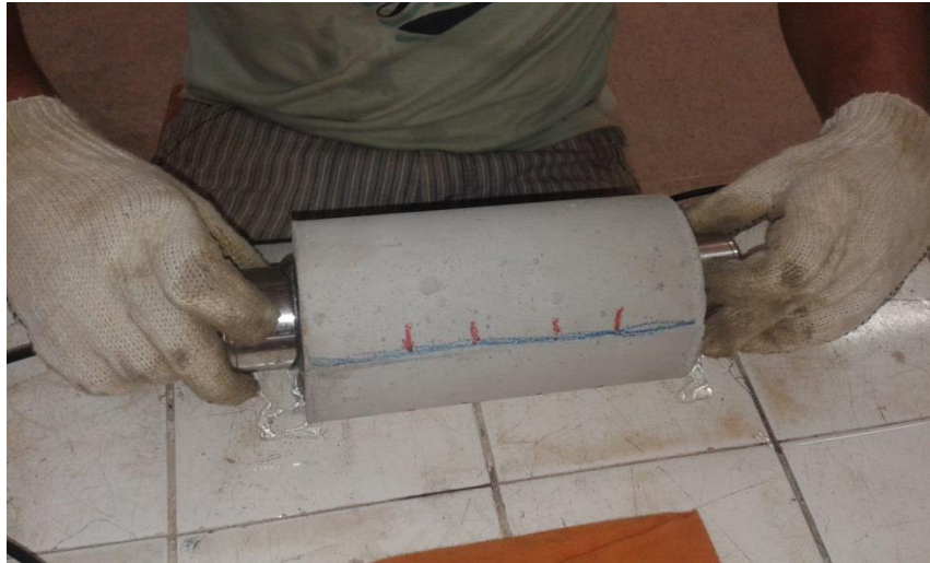
Figura 15 - Ensaio do Ultrassom, sendo realizado através de transmissão direta
