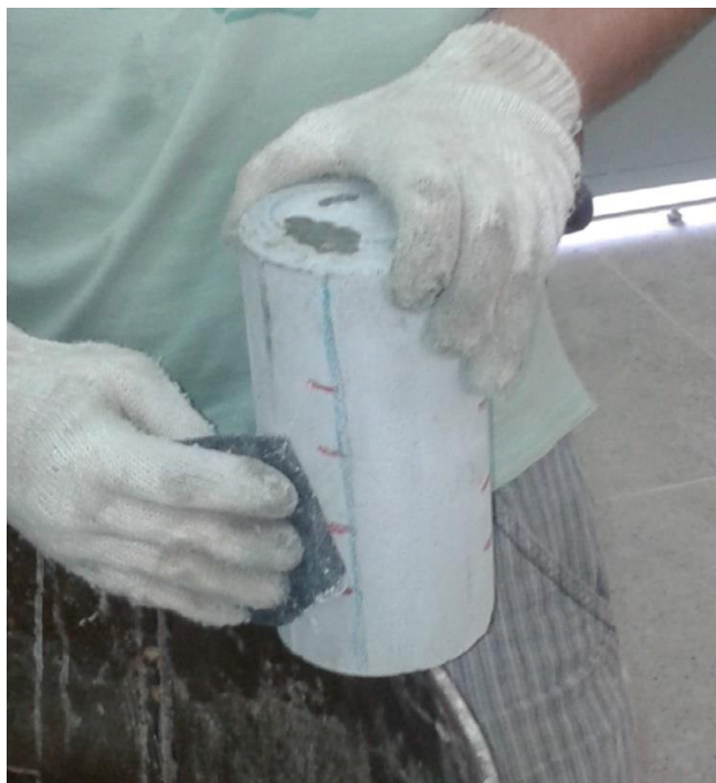
Figura 16 - Preparo da superfície para realização do ensaio de esclerometria
