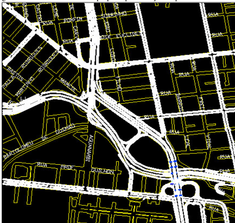
Figura 4.6 Desenho em CAD da proposta para solução do problema da rotatória.
