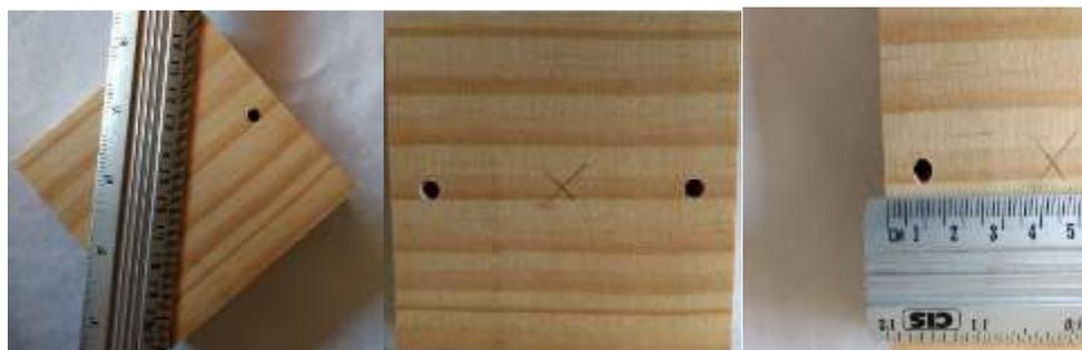
Cada elemento que for colocado tem uma broca ou equipamento diferente então ou você tem um paquímetro para medir as dimensões ou faz no olho com o equipamento e componente lado a lado. Recomendamos a utilização do paquímetro, pois será mais preciso no diâmetro da broca a usará.
