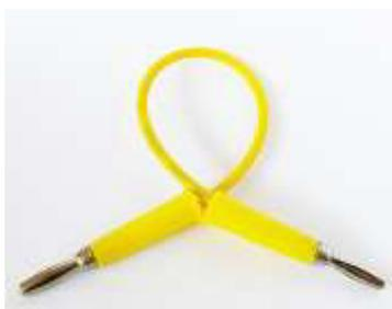
A inserção de novos elementos nos fez construir outros cabos que podem ser usados tanto na conexão entre elementos do equipamento ou, de elementos, com o multímetro.
