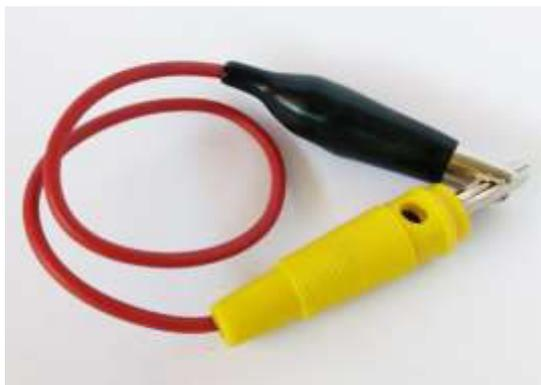
Fizemos dois cabos maiores, conforme a figura 10, para podermos conectar com a fonte variável. Os cabos foram feitos de cores diferentes para evidenciar qual é o polo negativo e o positivo.
