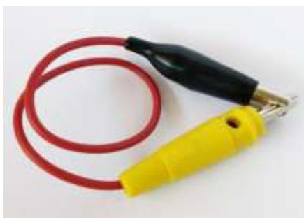
Fiz também dois cabos com cores não padronizadas para conectar a fonte variável ao circuito ou para fazer conexão que gostaria de destacar no circuito, conforme a figura 38
