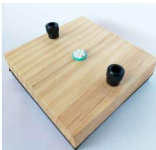
Lembrando que o LED quando ligado em corrente contínua precisa ser ligado respeitando o lado negativo e positivo, então quando conectá-lo no circuito e ele não brilhar inverta a corrente.
