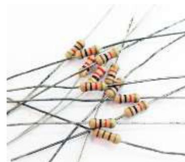
Os resistores são fabricados basicamente de carbono, podendo apresentar resistência fixa ou variável. Quando os resistores apresentam resistência variável passam a ser chamados de potenciômetros ou reostatos.
