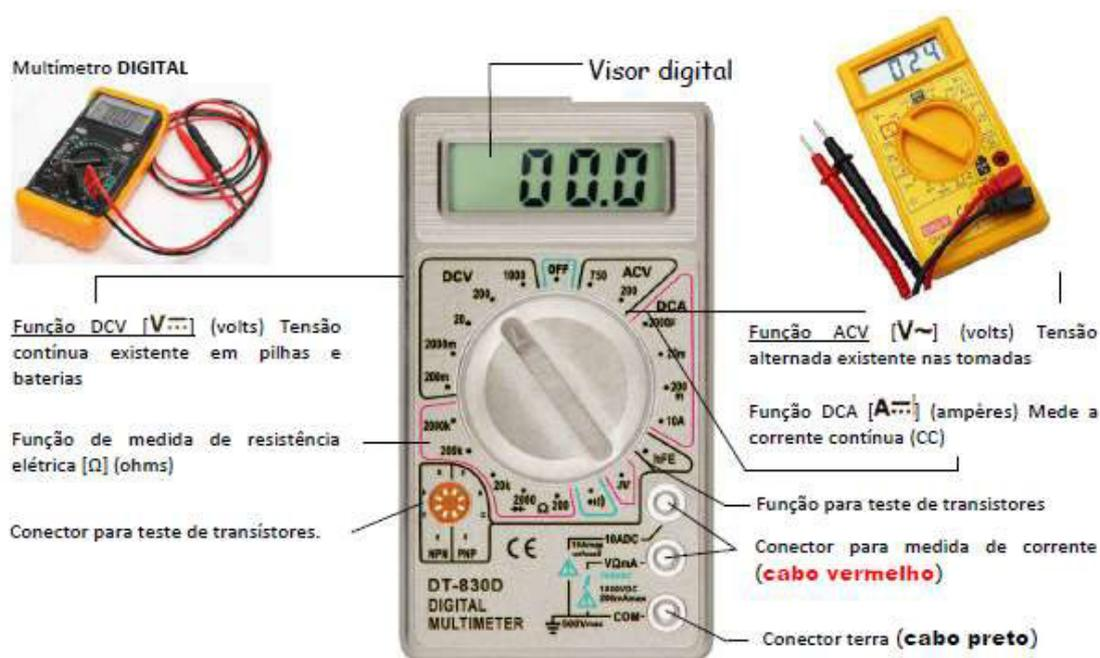
Em multímetros digitais, a escala já indica o máximo valor a ser medido por ela, independente da grandeza. As funções e escalas que vamos utilizar em nosso trabalho estão representadas na próxima Figura.
