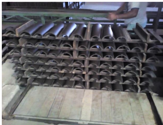
Figura 6 - Disposição das telhas em grades para a secagem em uma indústria de cerâmica no município de Russas, Ceará.
