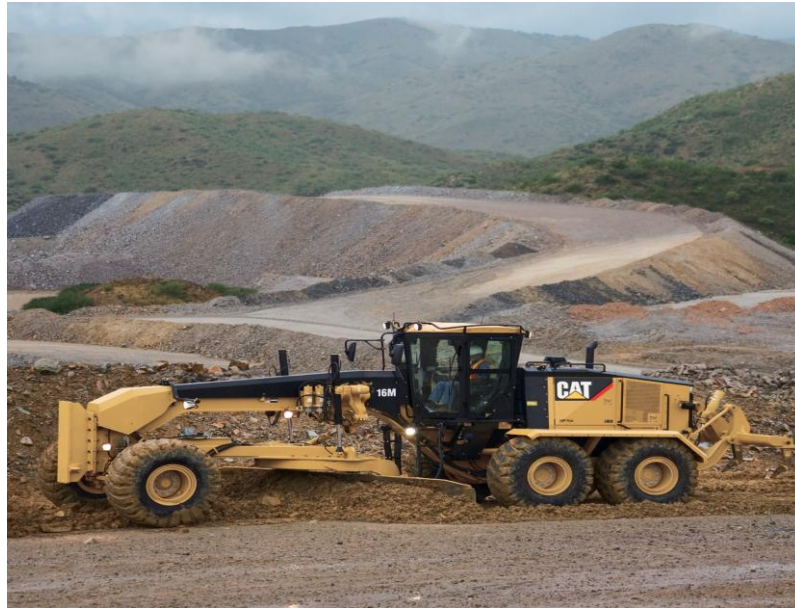
Figura 2.20: Motoniveladora. Fonte: CARTERPILLAR (2013).
