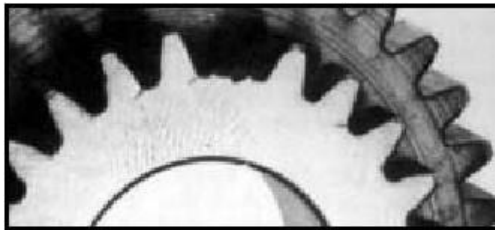
a) Ruptura por carga de impacto
