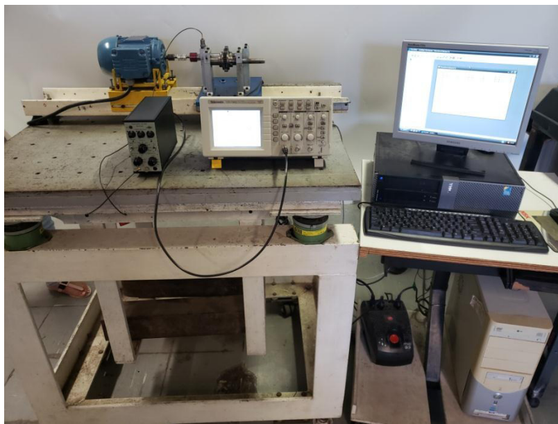
Figura 14- Bancada de teste de um par de engrenagens
