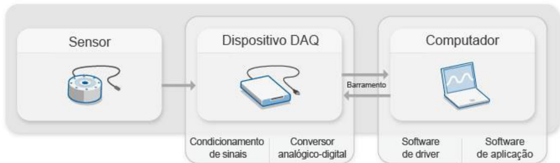
Figura 3 - Componentes de um sistema de aquisição de dados
