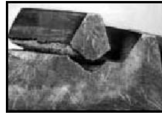
b) Ruptura por fadiga
