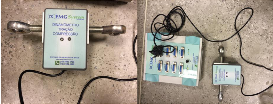
Figura 4. 2 Célula de carga e receptor de dados
