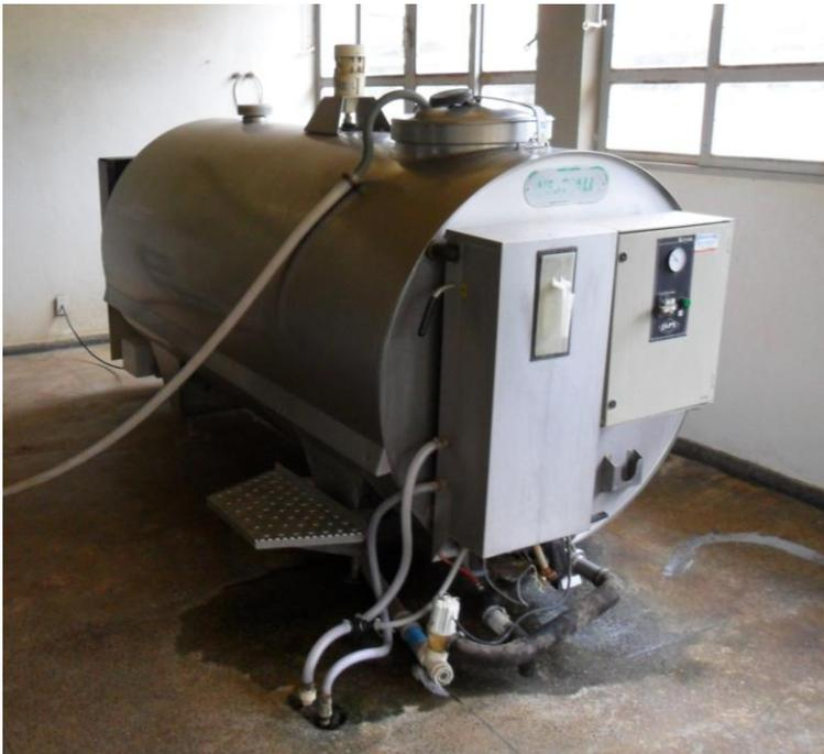
Figura 1 - Tanque de resfriamento do leite.
