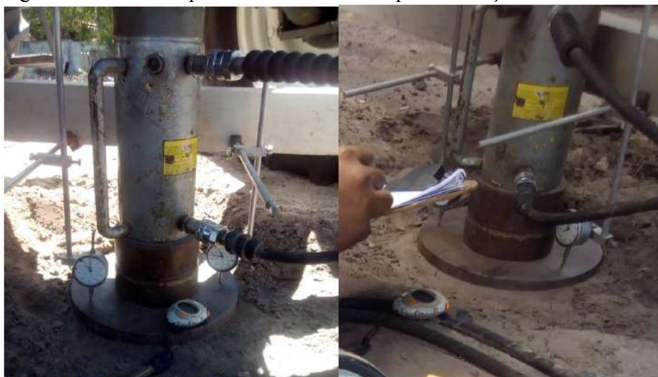
Figura 4 – Estado da placa metálica antes e após realização do ensaio em solo natural
