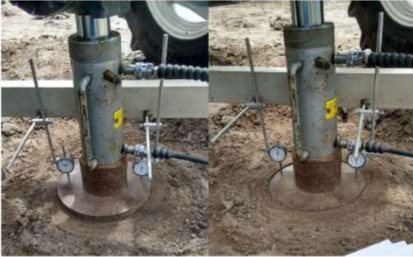
Figura 6 – Estado da placa metálica antes e após realização do ensaio em solo inundado
