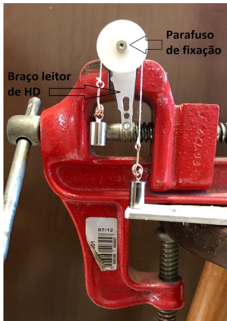
Figura 11 – Opção de montagem da roldana usando a articulação do braço leitor de disco rígido de computador.
