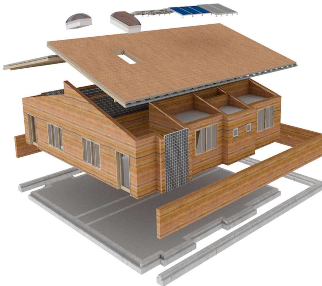
figura 23: Modelo explodido da habitação, salientando seus elementos de fundação, laje, paredes, aberturas e cobertura, além de mostrar os elementos técnicos de painéis fotovoltaicos e coletores solares.
