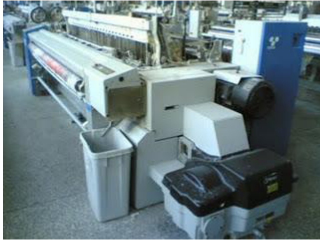
Figura 5: Ilustração Tear Jato de Ar.
