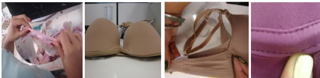
Figura 5.9 – Não conformidades: simetria, visual da peça, lateral estreita e furo de agulha.
