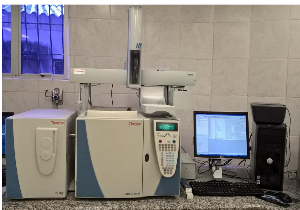
Figura 07 – Cromatógrafo a gás Trace GC ultra acoplado ao detector ITQ 1100
