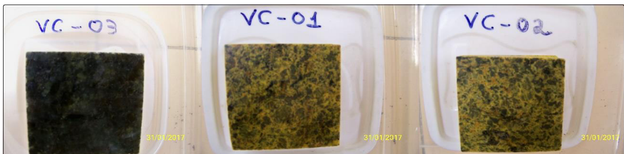
Figura 03 - Resultado visual do ensaio de alterabilidade após 180 dias.
