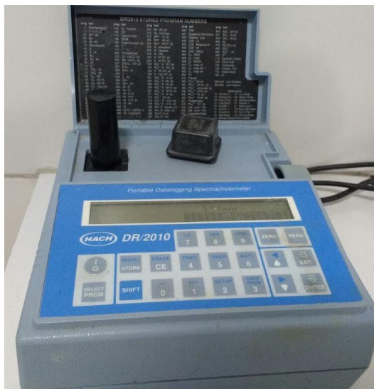
FIGURA 9. Espectrofotômetro utilizado na análise de nitrato com aplicação do método do salicilato de Sódio.
