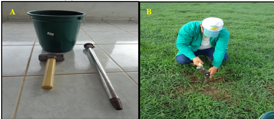
Figura 13 - Balde, marreta e trado tipo sonda pra coleta de solo (A); perfuração do solo até a profundidade de 40 cm (B)
