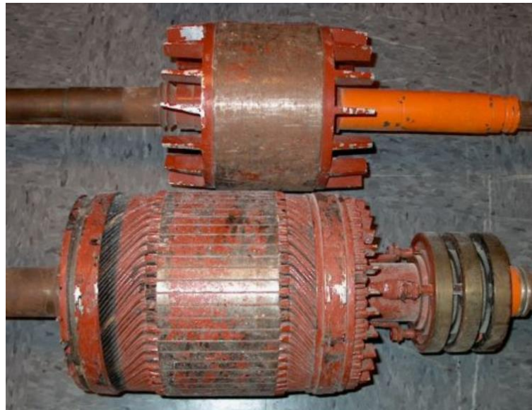
Figura 2.8 – Rotores em gaiola (superior) e bobinado (inferior)
