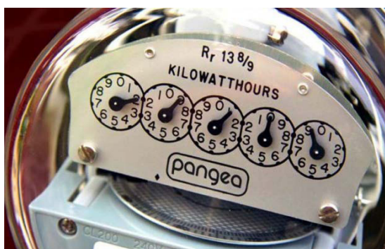
Figura 2 - Medidor eletromecânico com registrador de ponteiro
