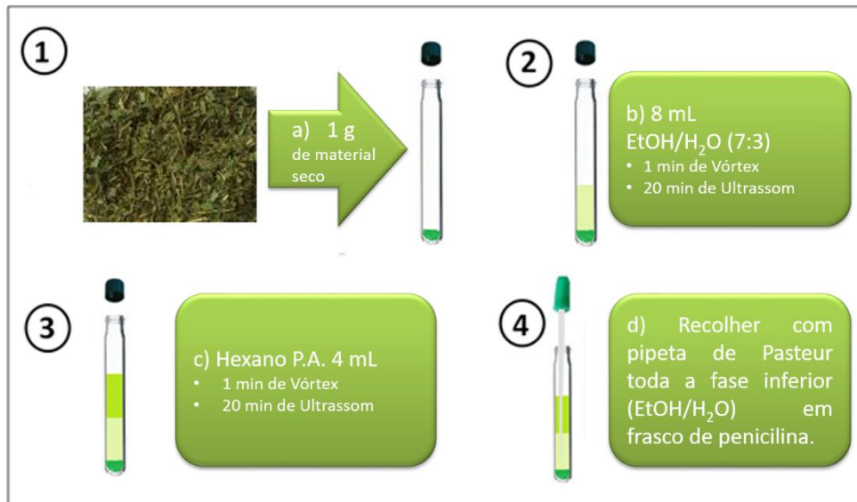
Figura 30 - Procedimento de extração líquido-líquido de BAGs usando o ultrassom.
