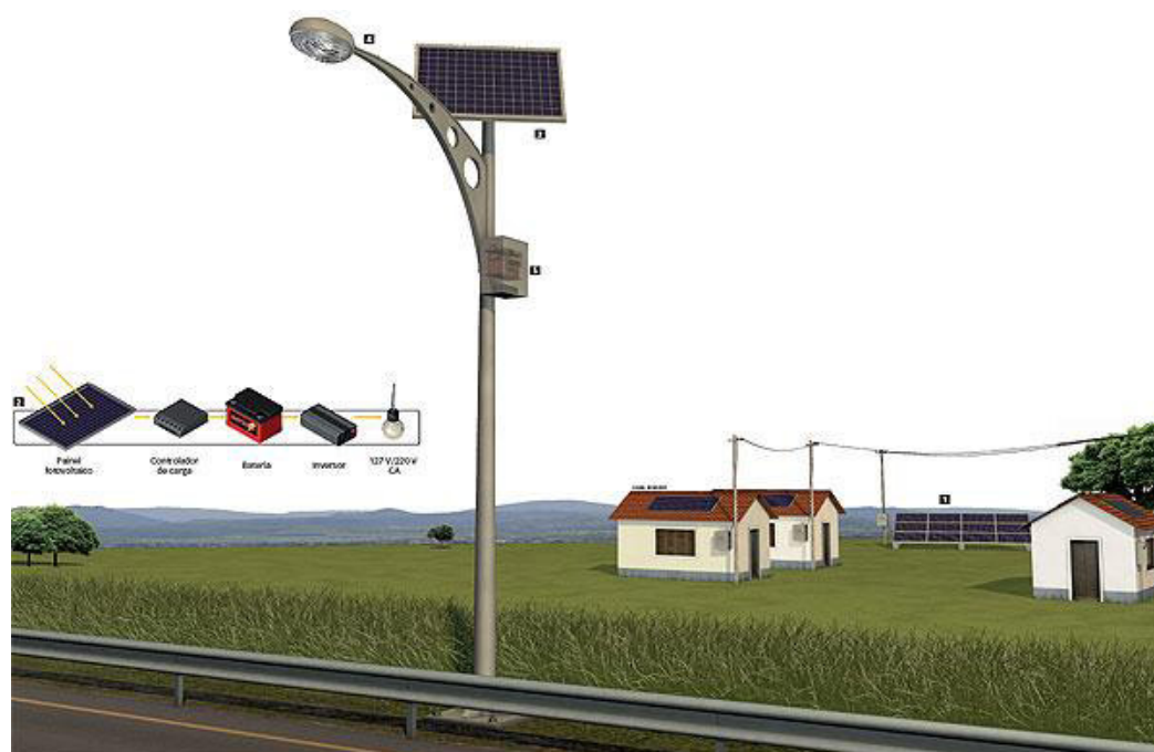
Figura 16- Sistema de IP por energia solar
