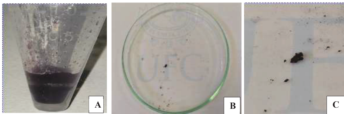
A: precipitado resultante após vários ciclos de centrifugação; B: pellet removido do tubo e posto em placa de petri e C: detalhe das AuNPs resultantes da secagem.
