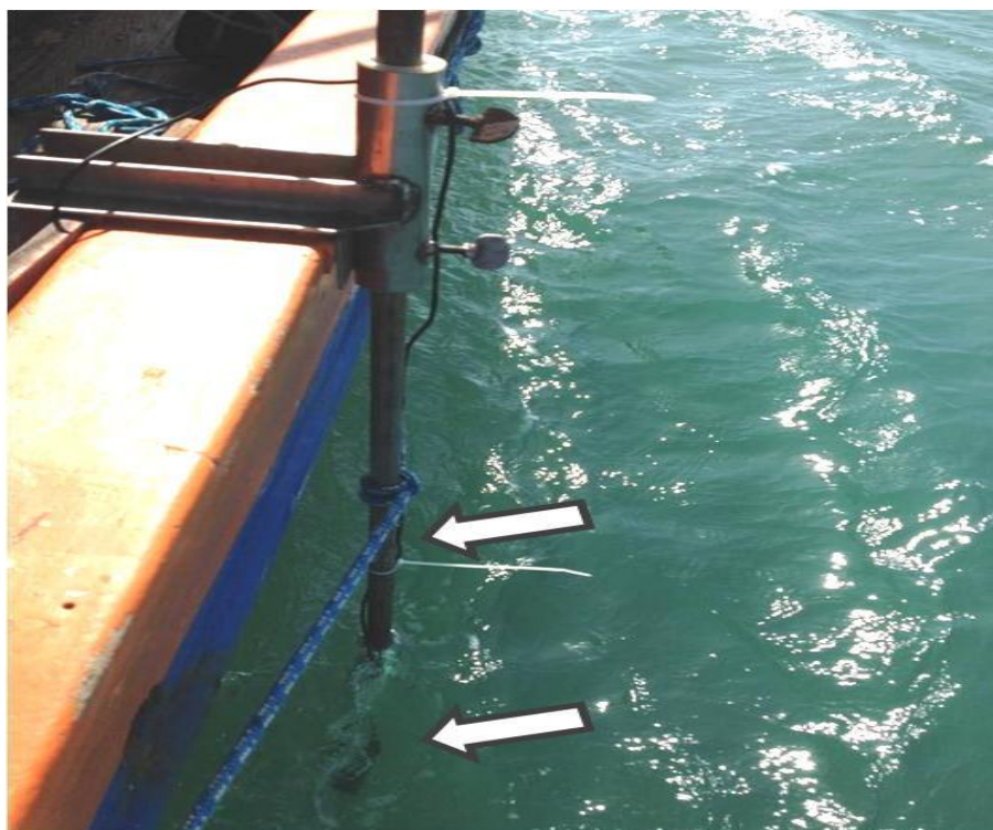
Figura 12 – Transdutor do GPS, posicionado a boreste da embarcação.
