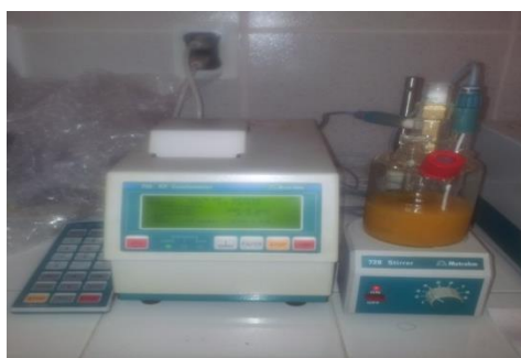
Figura 12 – Equipamento utilizado no ensaio de teor de umidade
