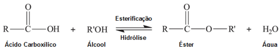
Figura 4 – Esquema da reação de esterificação de um ácido graxo. Destaque para a reação inversa, denominada de hidrólise do éster.
