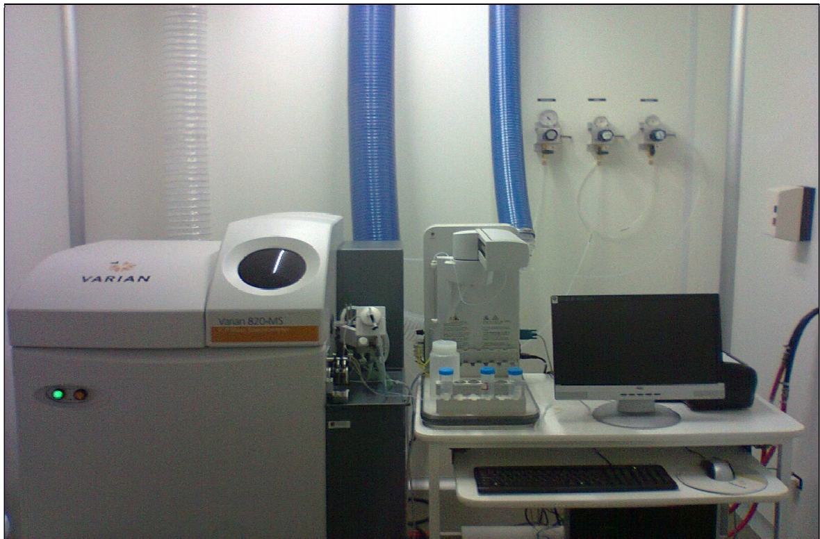
Figura 13-Equipamento ICP-MS (VARIAN 820MS) em funcionamento no Laboratório de Biogeoquímica Costeira (LABOMAR/UFC) em sala limpa classe 1000.
